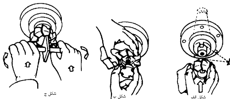
شکل ۱۸-۵ روش بستن تیغه فرزاها
