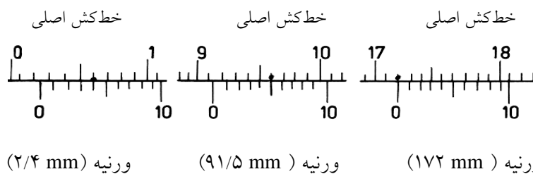
شکل ۱۳-۱ روش خواندن کولیس
