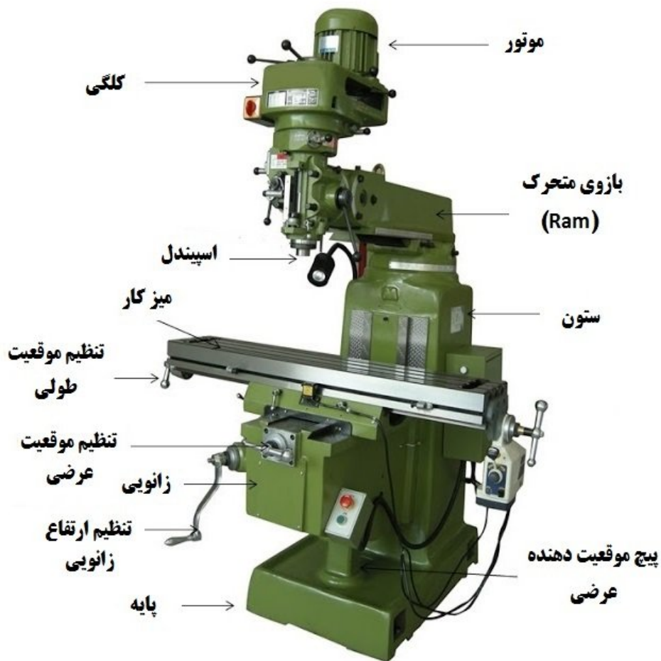
شکل ۴-۵ ماشین فرز عمودی
